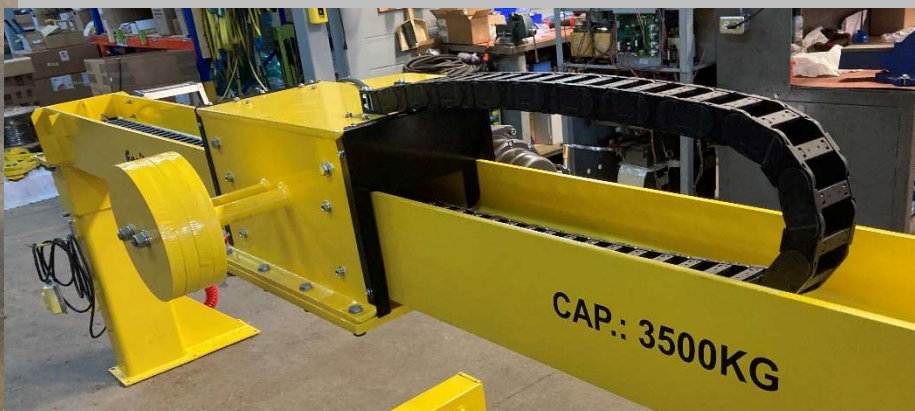
Chariot du treuil avec contrepoids de stabilisation
