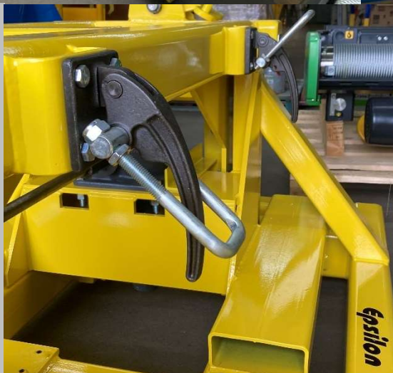
Mécanisme permettant de sécuriser les structures sur le chariot.
