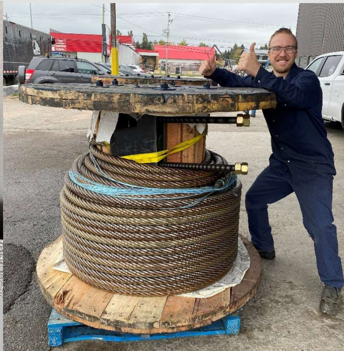
Notre employé pose fièrement devant un des câbles imposants qui est muni d'une attache spéciale permettant de fixer son extrémité à l'aide de 2 tiges filetées.
